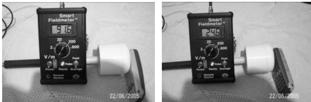
Εικόνα 4. Διαφορετικές εντάσεις ακτινοβολίας όπως μετρώνται σε διαφορετικές όψεις του ίδιου κινητού τηλεφώνου (91,6-πίσω πλευρά, έναντι 24,6 βολτ/μέτρο-εμπρός)
