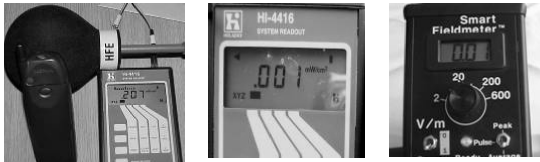
Εικόνα 2. Μέτρηση εκπεμπόμενης ακτινοβολίας από κινητό (αριστερά) σε \text{mW}/\text{cm}^2 σε σύγκριση με την ένταση της ακτινοβολίας του περιβάλλοντος σε χώρο απαλλαγμένο από ηλεκτρομαγνητική ακτινοβολία (κέντρο, σε \text{mW}/\text{cm}^2 ), (δεξιά σε βολτ ανά μέτρο).
