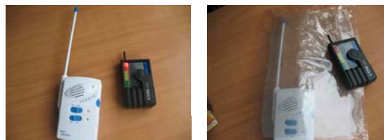
Εικ. 5 Εκπομπή ακτινοβολίας από συσκευή παρακολούθησης βρεφών μπορεί να αποτραπεί προς την κατεύθυνση του βρέφους εάν παρεμβληθεί πλαστικοποιημένο μεταλλικό πλέγμα (δεξιά εικόνα).
